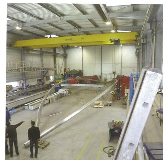
Vue des arcs et des poutres chéneaux durant la fabrication et le montage à blanc.
